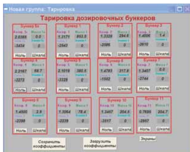
Рис. 5. Пример рабочего экрана системы управления
