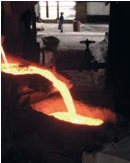
Рис. 3. Заполнение медью дозирочного ковша
