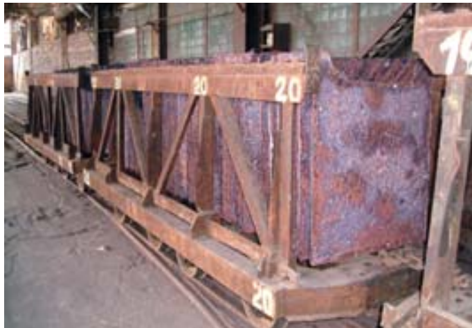
Рис. 6. Готовые аноды направляются в цех электролиза
