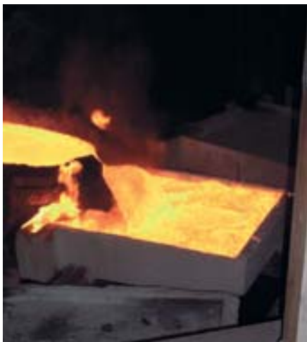
Рис. 4. Так отливается анод (заполнение изложницы медью)
