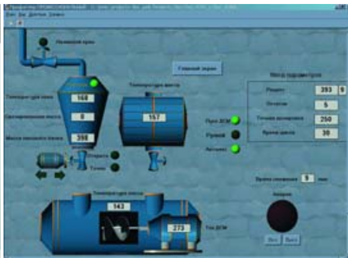
Рис. 9. Пример экранной формы АРМ оператора АСУ ТП дозировки пека
