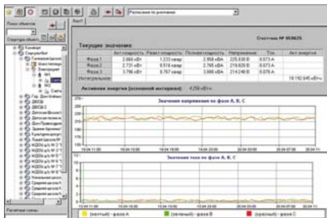
Рис. 5. Экранная форма (мнемосхема) для просмотра текущих значений потребления электрической энергии
