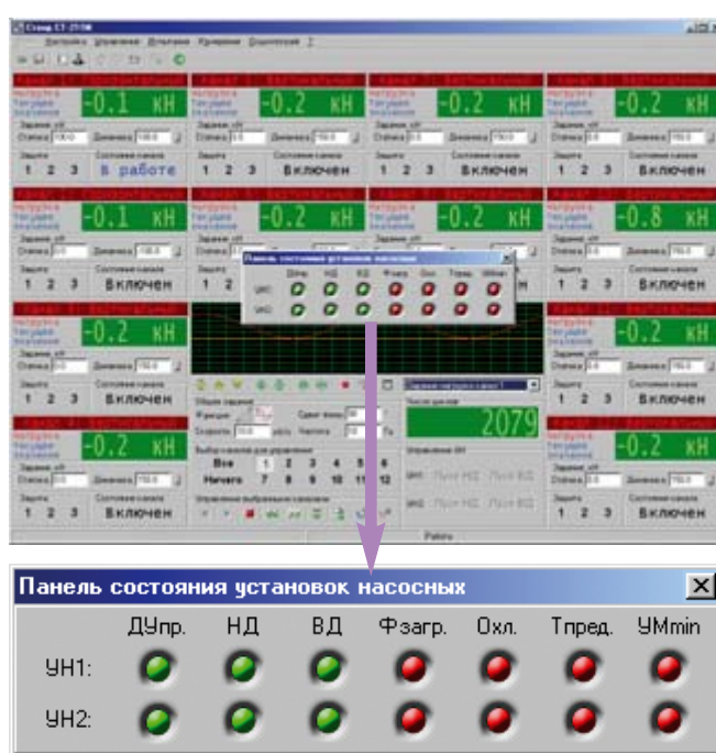
Рис. 6. Панель состояния насосных установок
