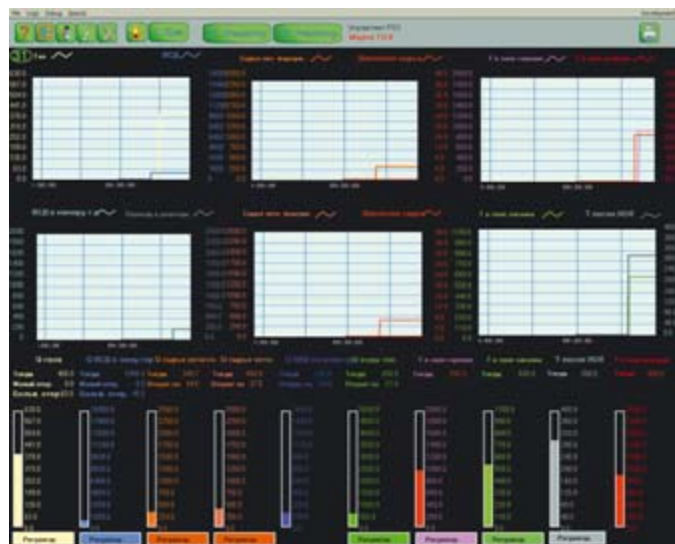
Рис. 9. Сводная мнемосхема, отображающая все основные параметры технологического процесса
