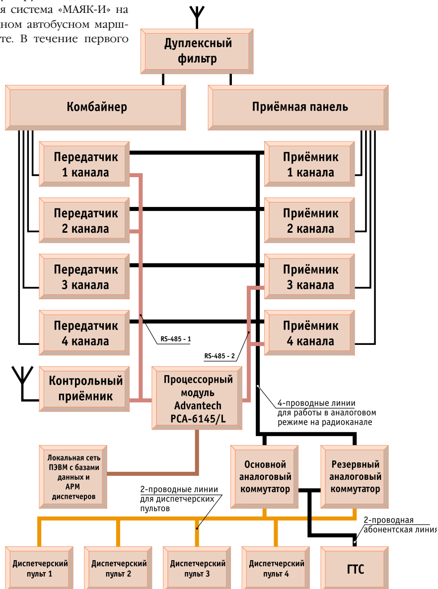
Рис. 9. Структура четырехканального базового центра системы «МАЯК-И»
