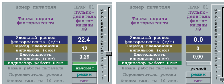
Рис. 5. Вид видеопульта управления питателем № 1 в автоматическом (слева) и ручном (справа) режимах
