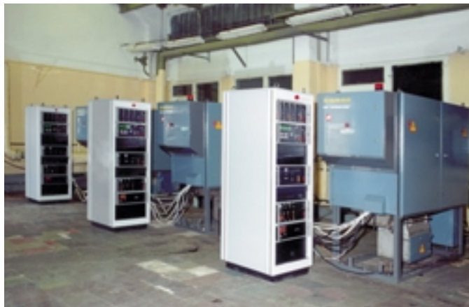
Рис. 1. Очередная партия готовых сепараторов во время испытаний в цехе предприятия
