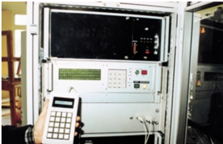
Подсистема управления Рис. 5. Блок управления с пультом технолога-обогапителя
