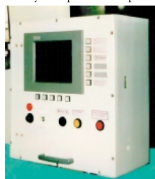
Рис. 2. Внешний вид прибора САУ АДГ 1000 4.1 для управления судовым дизель-генератором
