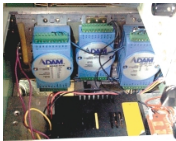
Рис. 3. Расположение модулей ADAM в стойке управления установки
