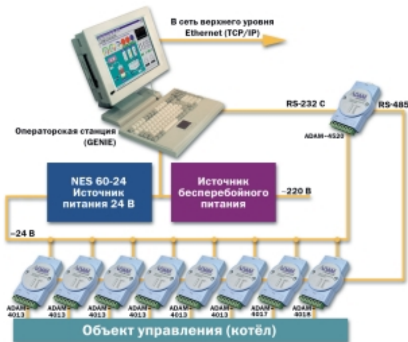
Рис. 1. Блок-схема автоматизированной системы контроля параметров водогрейного котла КВГМ-180
