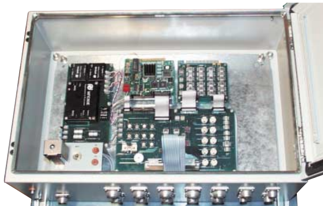
Рис. 7. Устройство накопления и обработки информации УНО-84П
