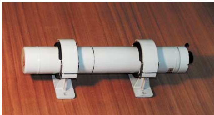
Рис. 1. Блок детектирования мощности гамма-излучения БДМГ-08Р-03
