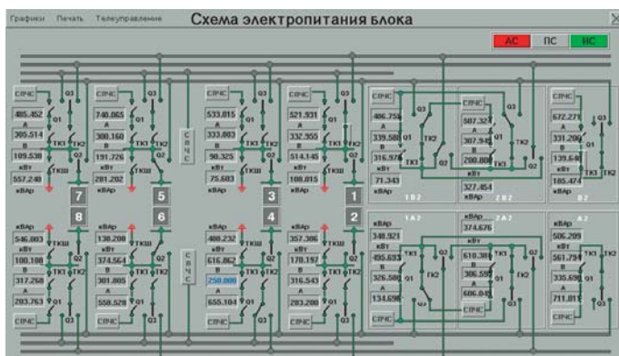
Рис. 4. Мнемосхема отображения состояния оборудования блока электропитания
