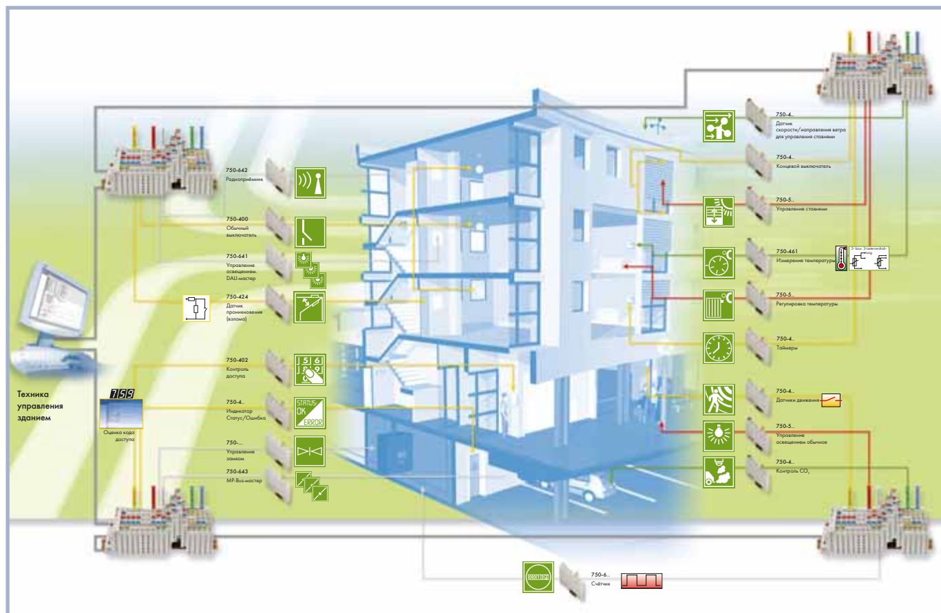
Рис. 2. Система автоматизации задания с использованием ПЛК WAGO I/O серии 750
