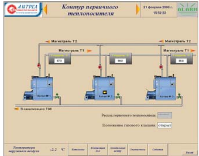
Рис. 7. Мнемосхема, отображающая состояние контура первичного теплоносителя котельной
