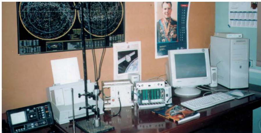
Рис. 1. Опытный образец бортового терминала на этапе наземных испытаний
