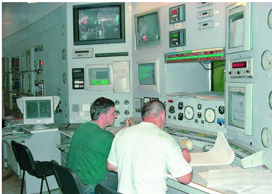
Рис. 1. Бокс, оснащённый стендовым комплексом вибрационной диагностики газотурбинных двигателей
