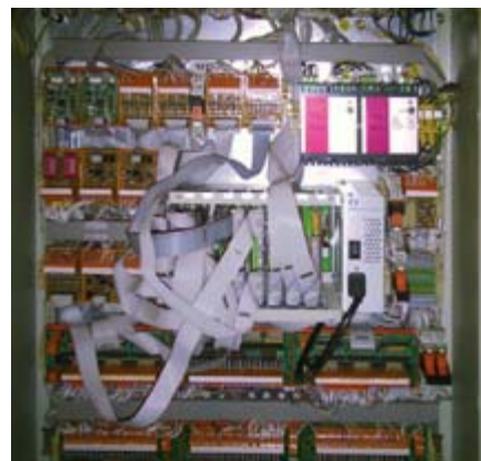
Рис. 4. Каркас с модулями MicroPC в составе аппаратуры КПА АУРК
