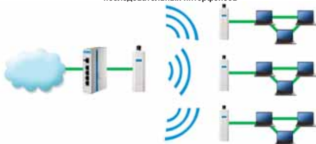
Связь через беспроводные серверы последовательных интерфейсов
