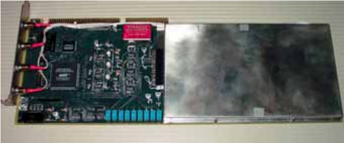
Рис. 6. Внешний вид платы первичного контроля (приёмопередатчики в правой части платы закрыты защитным экраном)
