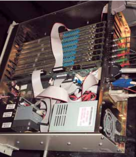
Рис. 5. Внутренняя компоновка промышленного компьютера, выполненного на базе шасси IPC-610
