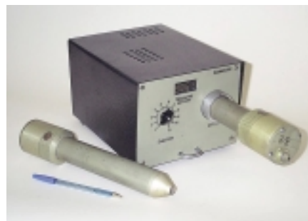
Рис. 6. Общий вид устройства сравнения датчиков
