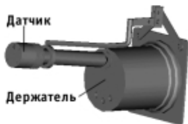
Рис. 4. Конструктивное исполнение держателя с датчиком
