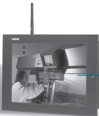
Передняя панель со степенью защиты IP65 и сенсорным экраном
