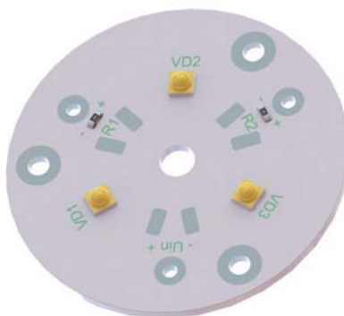
Рис. 5. Круглый кластер XLD-AC1x03-01 с тремя светодиодами
